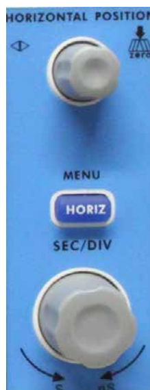
Abb. 11 Bedienelemente für Horizontalsteuerung
