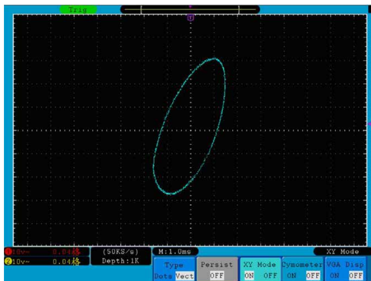
Fig. 45 XY Display Mode
