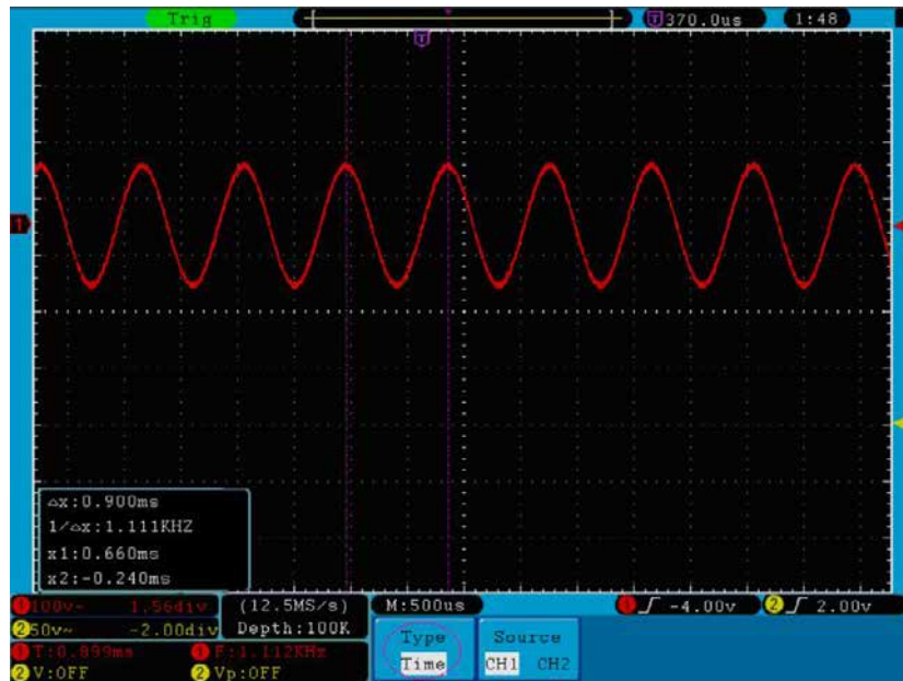
Abb. 72 Wellenform bei der Messung mit dem Cursor
