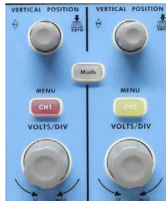
Abb. 10 Bedienelemente für Vertikalsteuerung
