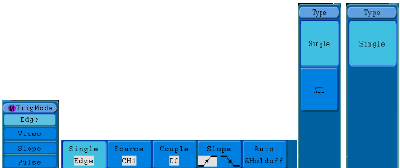
Fig. 29 Edge trigger menu
