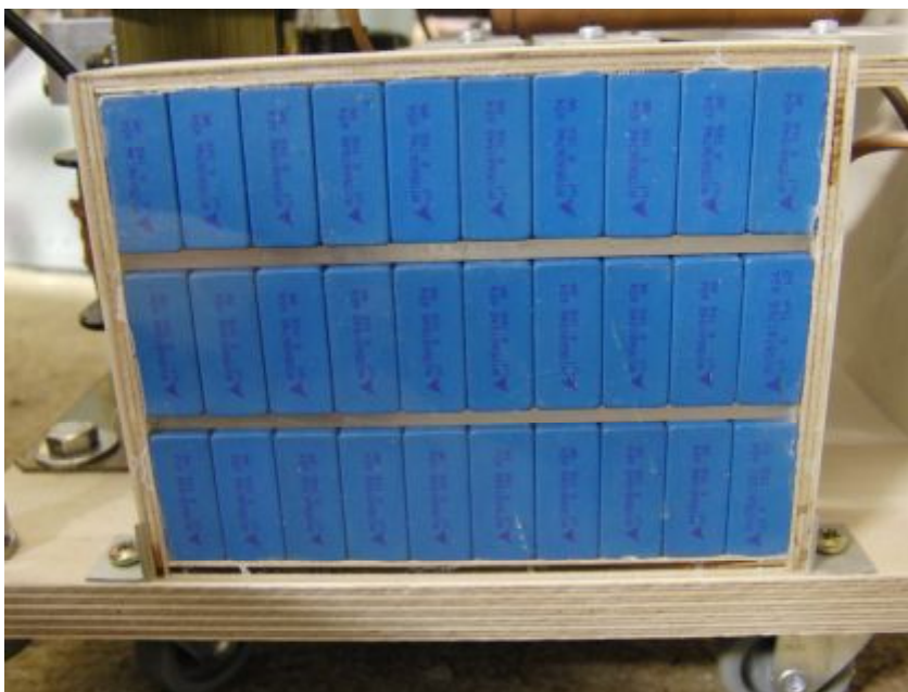
Abbildung 8: MMC, 10 Stück in Reihe (String), drei Strings parallel
