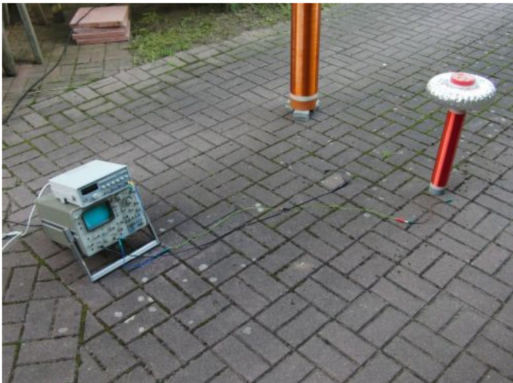
Abbildung 12: Bestimmung der Resonanzfrequenz der Sekundärspule am lebendem Objekt mit Sinusgenerator und Oszilloskop
