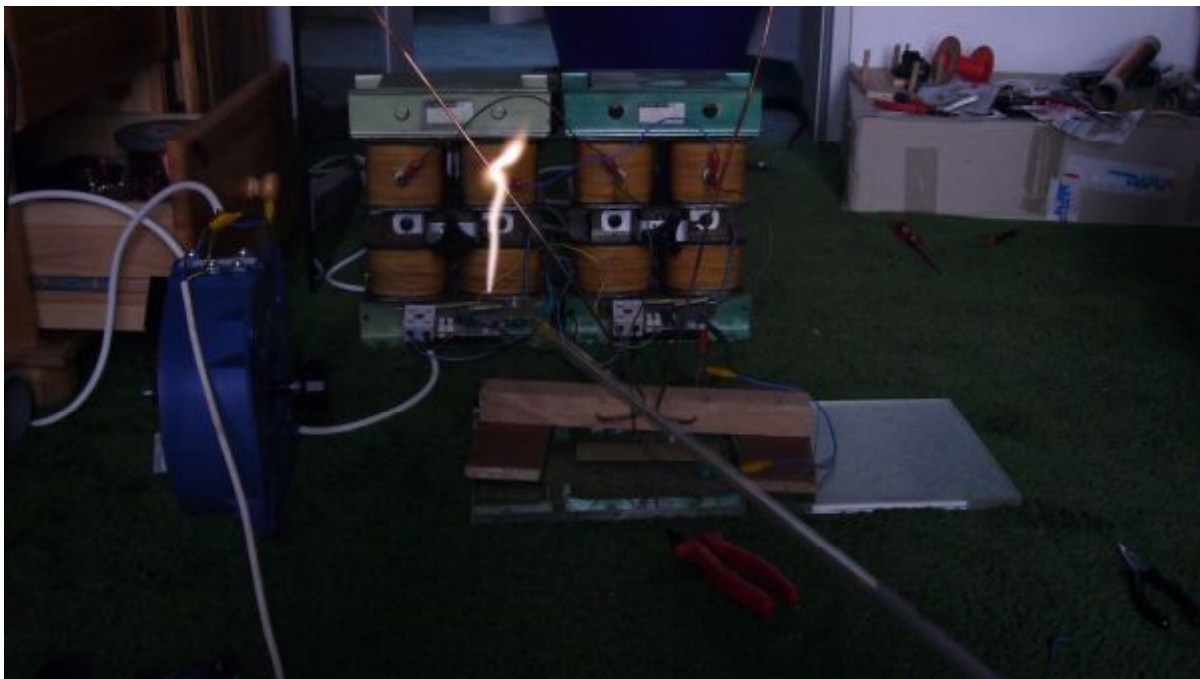
Abbildung 16: Lichtbogen mit zwei Neontrafos, Temperatur über 2500 Grad Celsius
