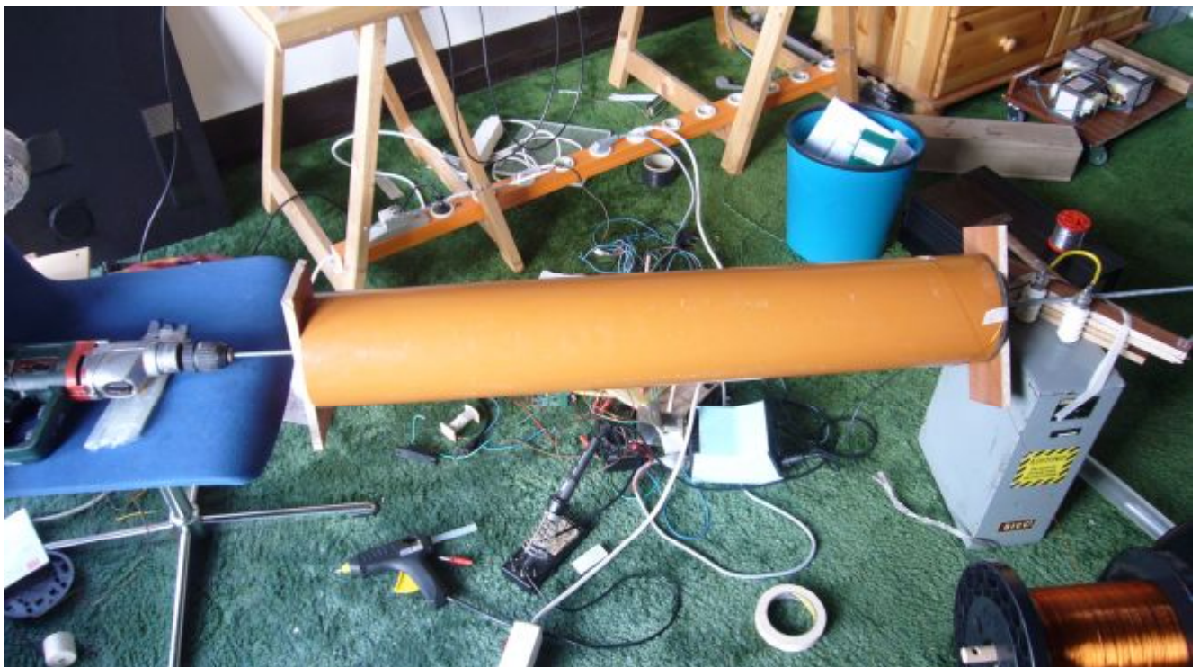
Abbildung 10: "Kunstvolle" Wickelmaschine für Sekundärspulen, funktioniert aber!
